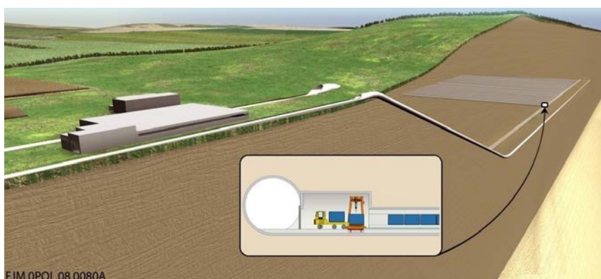
Figure 5 : Schéma de principe d'un stockage sous couverture intacte (SCI)
