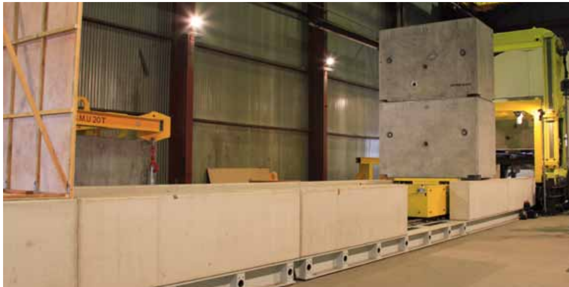
● Démonstrateur de pré-empilage pour certains colis de stockage MA-VL
