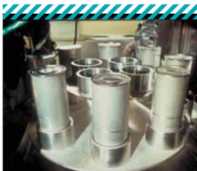
Boîtes contenant de l'oxyde de plutonium, en attente de fabrication de combustible MOX.
