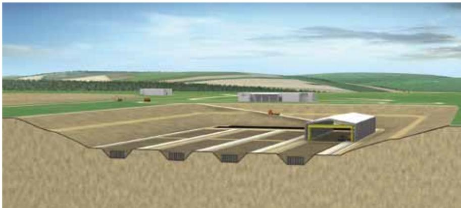
**Stockage FAVL à faible profondeur, de type stockage en couverture remaniée.** La roche est excavée à ciel ouvert. Après stockage des déchets, la zone est remblayée avec les matériaux naturels extraits du site.
