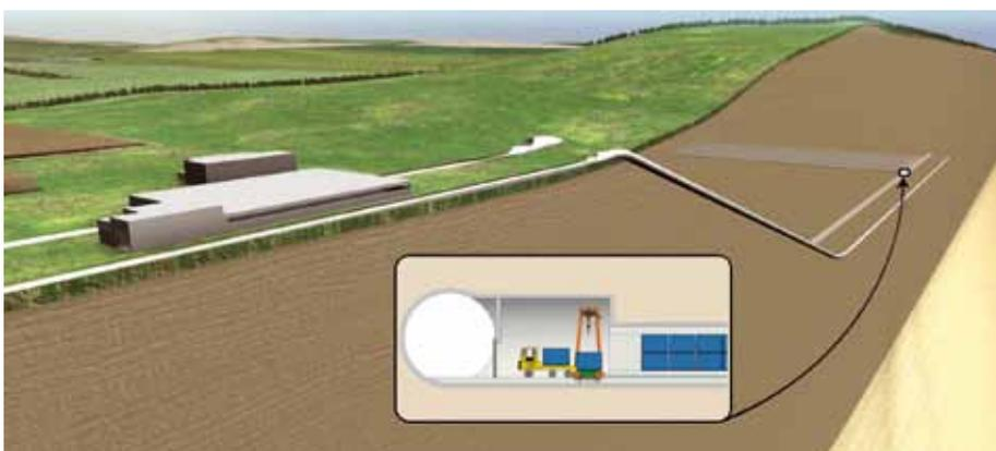
**Stockage FAVL à faible profondeur, de type stockage en couverture intacte.** Le stockage est creusé en en sous-sol ; les galeries d'accès sont remblayées une fois les déchets stockés.
