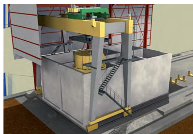
3 Stockage dans l'ouvrage à l'aide d'un pont spécifique
