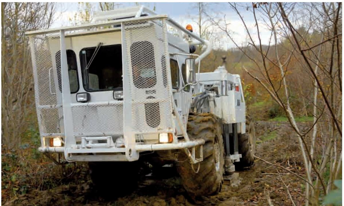
Camion-vibrateur utilisé pour les travaux d'études en Meuse/Haute-Marne
