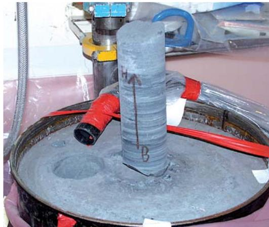
Un système de carottage pour prélever un échantillon des différents composants du colis (enveloppe et déchets).
