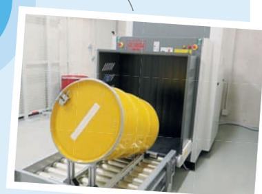
par cimentation. Certains colis de déchets solides (environ 20 %) sont contrôlés par scanner à rayons X dans ce nouveau bâtiment. À terme, les têtes de paratonnerres radioactifs y seront également démontées.
