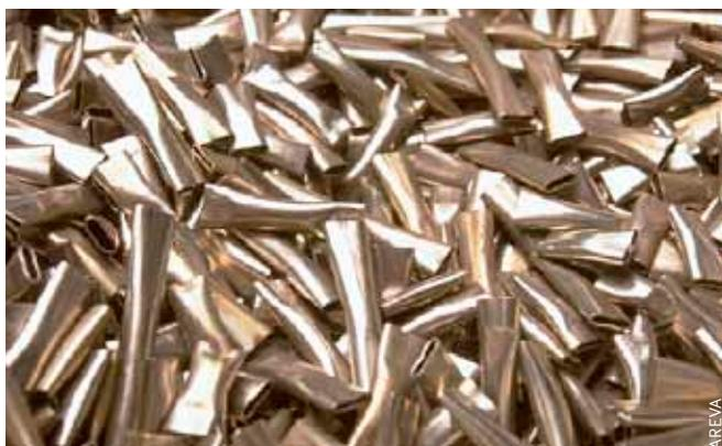
▲ Débris métalliques issus des structures entourant les combustibles usés (coques)
