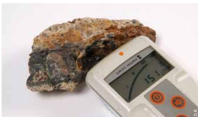
▲ Mesure de la radioactivité d'un morceau de minerai d'uranium
