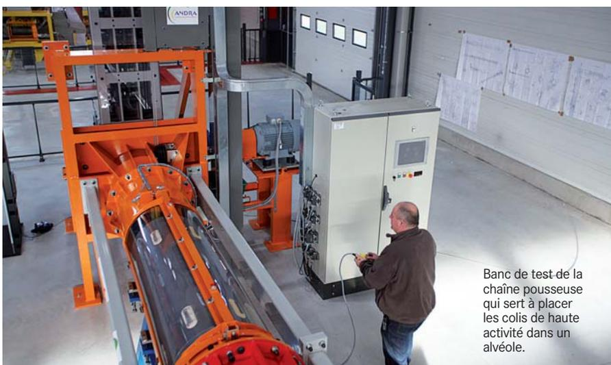
Banc de test de la chaîne pousseuse qui sert à placer les colis de haute activité dans un alvéole.
