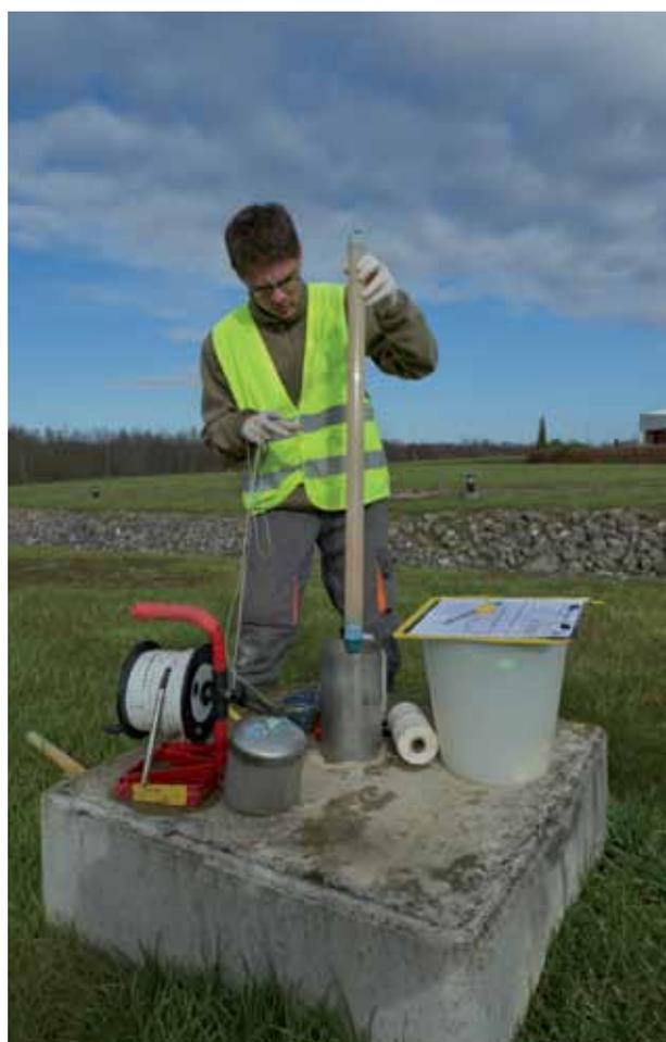
Surveillance des nappes à l'aide de piézomètres
