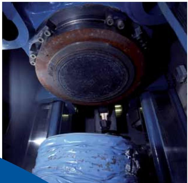
Presse à compacter permettant de réduire le volume des déchets avant leur stockage
