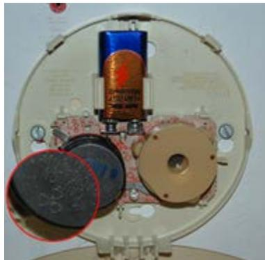
Figure 10 Détecteur ionique de fumée démonté à l'américium 241
