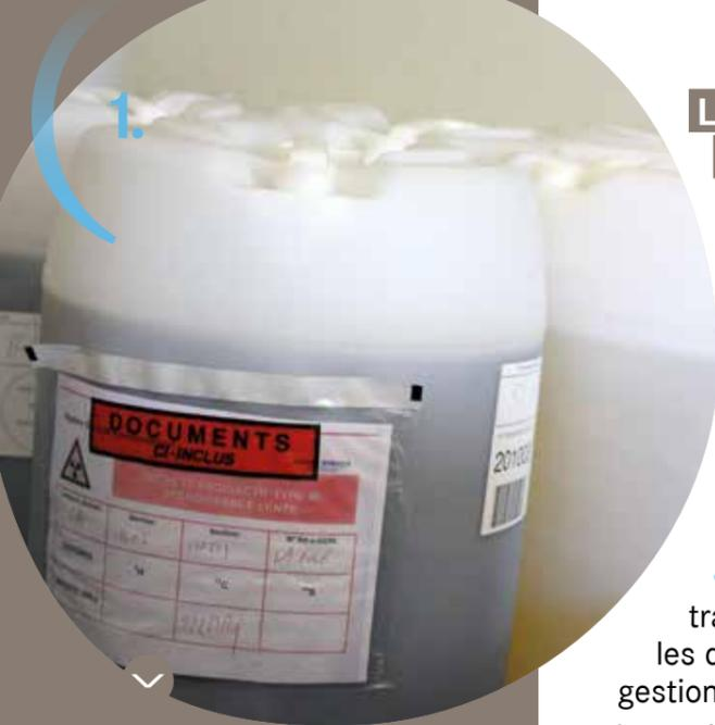
Solvants radioactifs regroupés au Cires avant d'être envoyés vers une autre installation pour traitement
