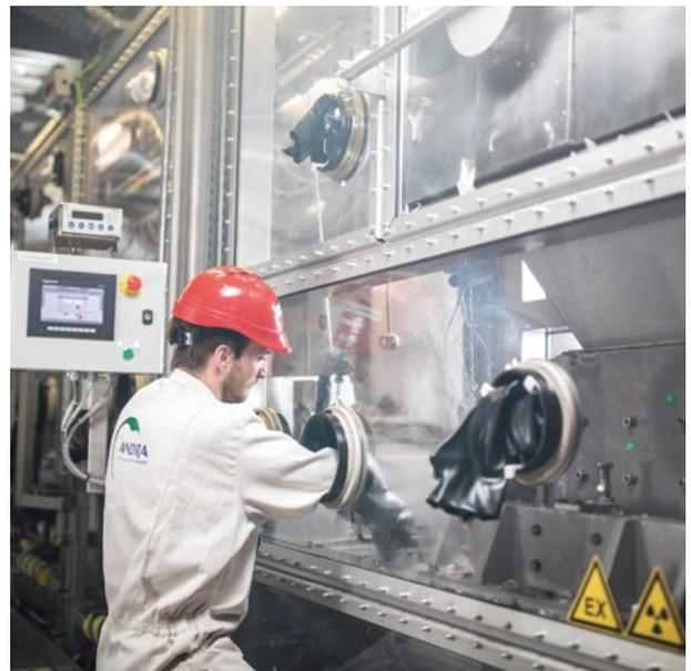
Opérateur manipulant des fioles de scintillation dans une boîte à gants
