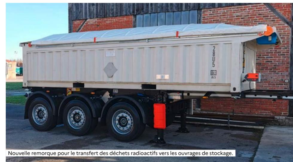
Nouvelle remorque pour le transfert des déchets radioactifs vers les ouvrages de stockage.
